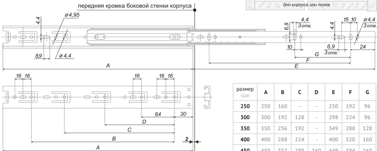
Примечание: предельно допустимое отклонение приведенных размеров  $\pm 0,5$  мм.
