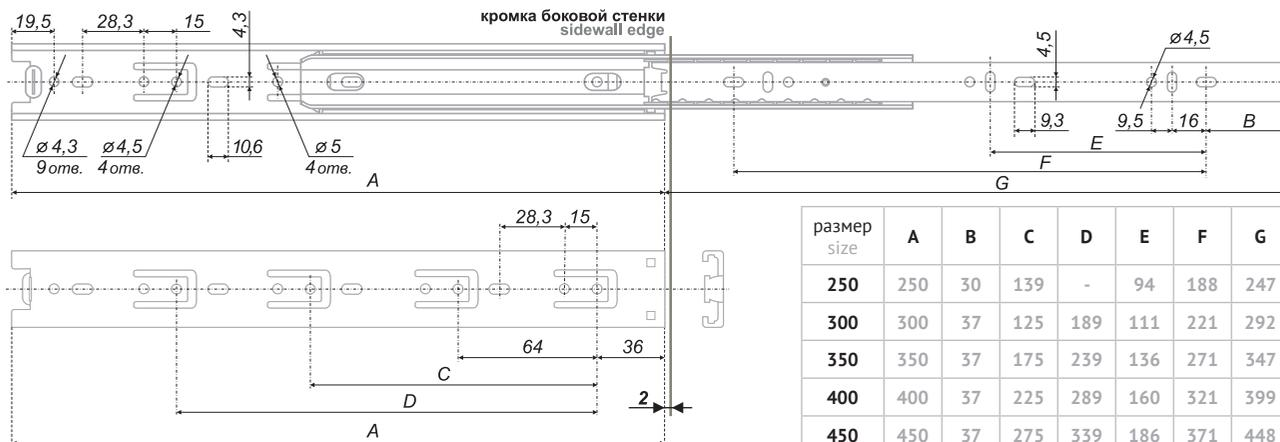
Примечание: предельно допустимое отклонение приведенных размеров  $\pm 0,5$  мм.
