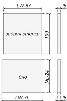
Размеры дна и задней стенки ящика
