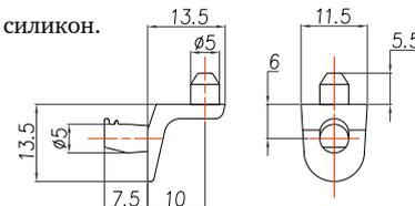
**Фиксатор задней стенки**
