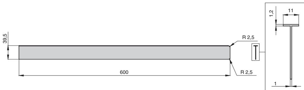
профиль R2,5 стыковочный 90° и соединительный для столешницы Н. 38,8
