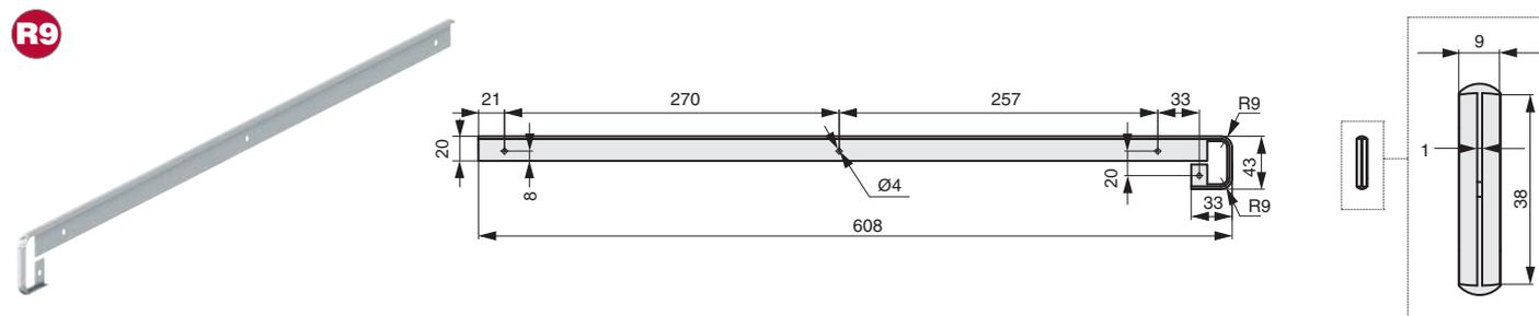
профиль соединительный R9 T-образный для столешницы
