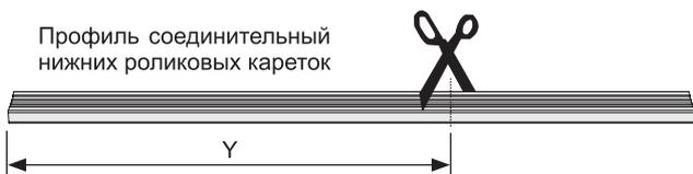
V - размер для резки верхней и нижней направляющих, верхней и нижней профиль-заглушек
