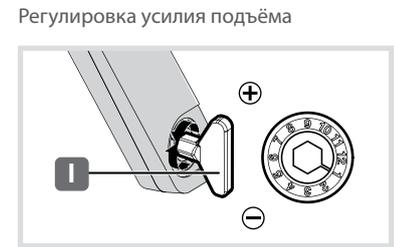
Регулировка усилия подъёма
