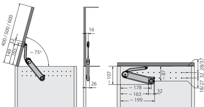
Схема установки MAXI UP с смягчителем удара
