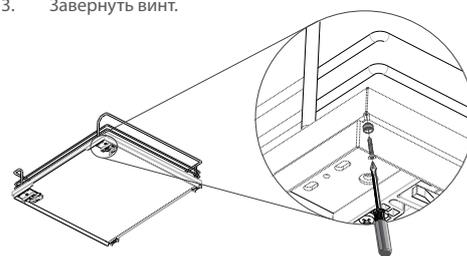
Установка на корзину АРЕНА защитного ролика, препятствующего повреждению тыльной стороны фасада.
