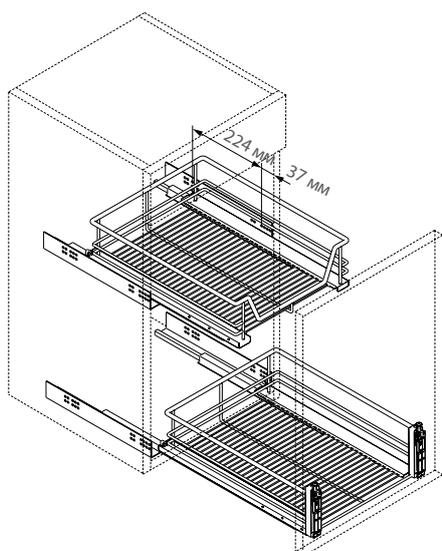
Схема регулировки в зависимости от толщины стенок каркаса в случае использования корзины АРЕНА
