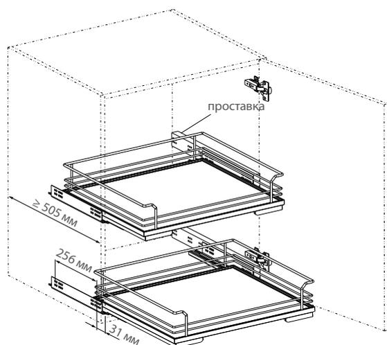
Схема регулировки в зависимости от толщины стенок каркаса в случае использования корзин АРЕНА
