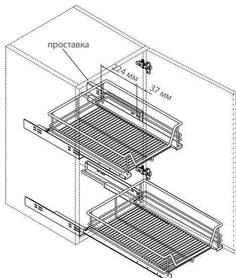
Схема регулировки в случае использования сетки при каркасе из 19 мм ДСП
