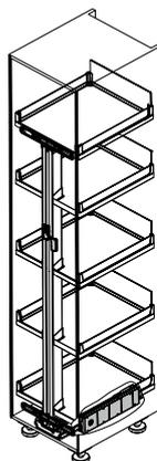
установка комплекта eTouch в механизм КОНВОЙ ЦЕНТРО и КОНВОЙ ЛАВИДО.
