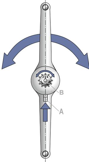
При нажатии на специальный переключатель (А) достигается возможность поворота верхнего рычага как в одну, так и в другую сторону.
